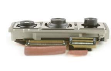
从iFixit的拆解图可以看到,P20 Pro的3颗摄像头均支持光学防抖功能
