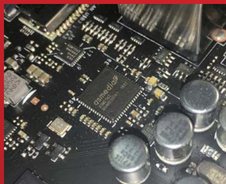
■ 板载祥硕ASM2142 USB 3.1 Gen2主控芯片,并配备了1个Type-C和1个Type-A接口。
