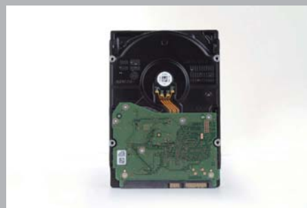
>>电气元件都安置在PCB板反面, 能有效防止静电及物理性损坏。
