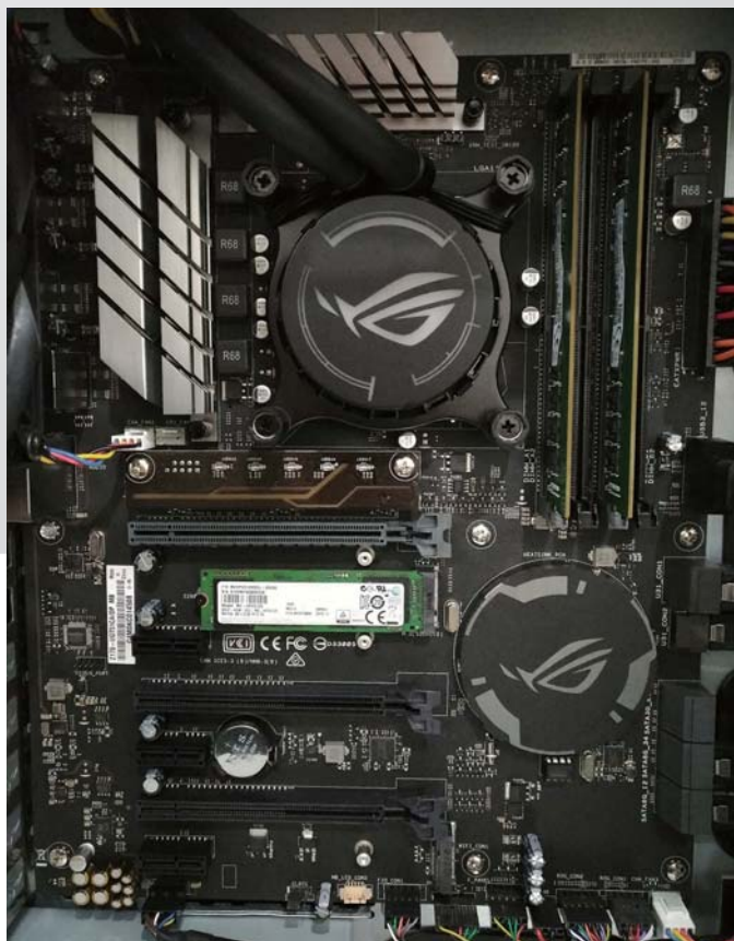
■ 主板为华硕自家定制的Z170-E GT51CA定制版，美中不足的是供电仅为“4+1相”设计，这对整机稳定性可能会带来不良影响，我们将通过长时间烤机测试来加以观察。
