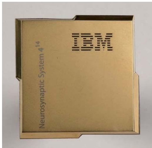
■ IBM第二代认知计算芯片TrueNorth实物
