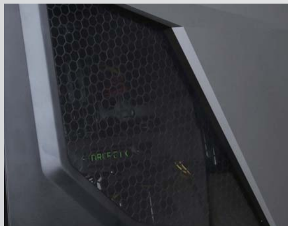
■ 通过侧透面板可以清楚地看到主板区域的工作情况以及灯效，或许是出于辐射防护或视觉方面的考虑，侧透面板与主板区域之间另有一层蜂窝状金属网
