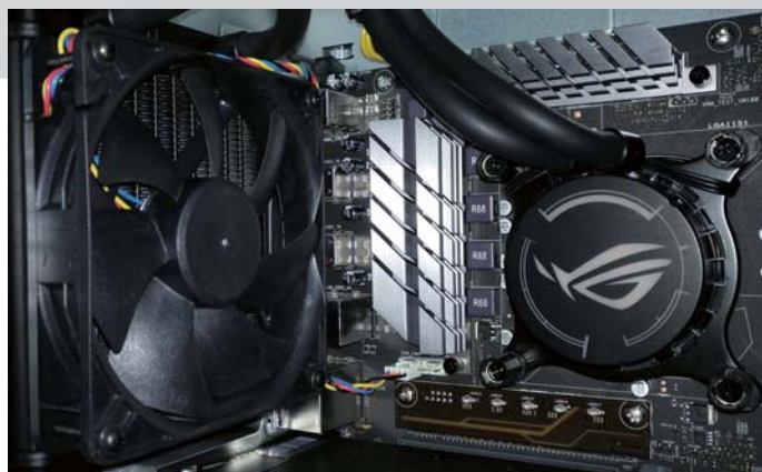
■ 120mm单排水冷，冷头顶部配备可发光的ROG品牌Logo。
