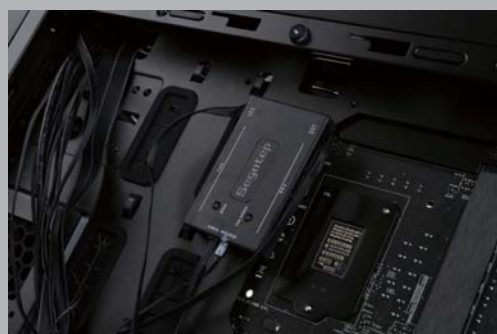
>> 机箱内部搭配的一个RGB S-link System灯效控制器
