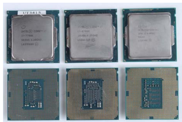
■ 3款处理器外观对比,我们可以看到,Core i7 7700K的顶盖和其他两款CPU有明显区别,一眼就能辨别出来。而Core i7 7700K处理器背面布局和Core i7 6700K并无太大差别,但Core i7 7700K的电容的体积更小。(左:Core i7 7700K,中:Core i7 6700K,右:Core i7 4790K)
