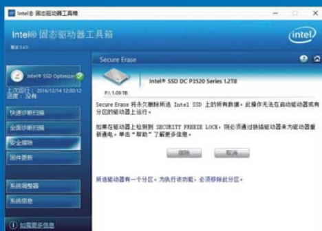
■ 固态硬盘工具箱中的SSD Optimizer与安全擦除功能,可有效恢复SSD在长时间使用后的性能。
