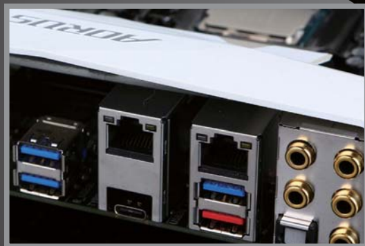
■ 两个RJ-45网络接口分别配以Killer E2500千兆网络芯片和Intel千兆网络芯片。
