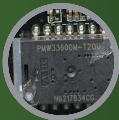
赛睿Rival 500游戏鼠标的光学引擎为原相PMW3360DM,它具备高达16000的CPI数值。
