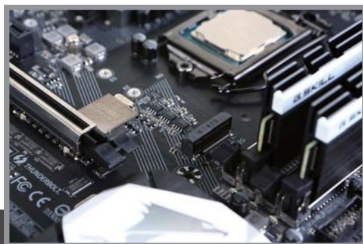
■ 该主板配备两个M.2接口,能较好发挥NVMe SSD的性能。
