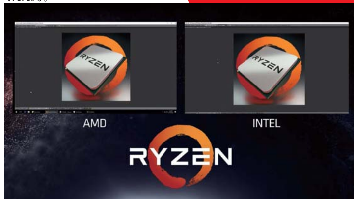
■ 在 RYZEN进行Blender渲染工作时, RYZEN处理器所需要的渲染时间(35.57s)也略少于Core i7 6900K(36.01s)。
