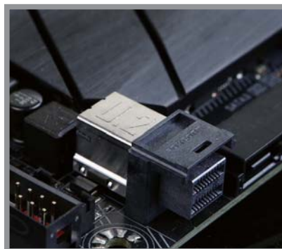
■ U.2接口同样走PCIe通道,其传输速度能够达到32Gb/s。
