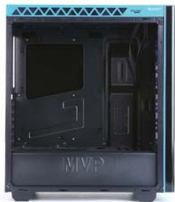
>> 采用ATX2.0结构,内部空间很大。
