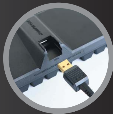
■ 镭拓MXX RGB机械键盘采用了可拆卸USB设计
