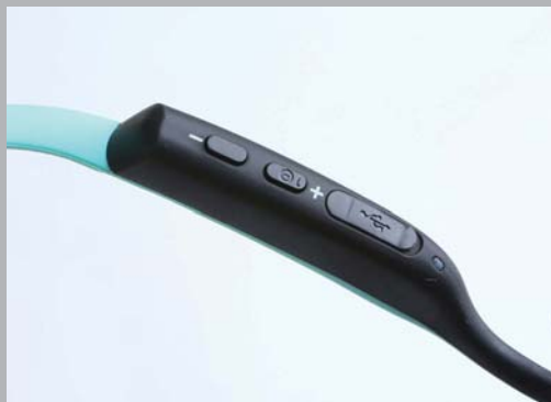
>>电源按键整合到音量增加键上,更适合单手盲操作。
