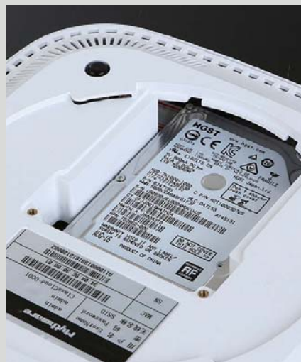
>> 拆开底部螺丝可以看见 2.5 英寸硬盘位, 最大支持 8TB 容量硬盘。
