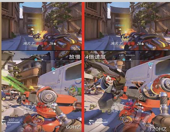
120Hz与常见的60Hz刷新率下的同一时刻游戏画面观感差别示意图。普通场景下两者差异不大（图上），更高的刷新率在激战中有助于玩家更稳定、更快地看清场面局势或发现迎面扑来的敌人（图下）。观感上哪怕只有0.1秒的差异，在诸如《守望先锋》、《CS GO》等FPS游戏中有时却足以决定胜负。
