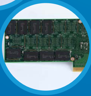
■ 英特尔SSD DC P3520系列1.2TB主要由26颗英特尔3D NAND MLC闪存、一颗SSD主控芯片、五颗美光缓存芯片组成。
