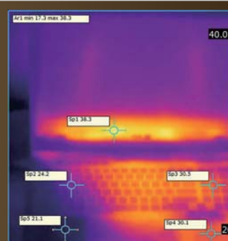
烤机后热成像显示，机身正面最高温度为38.3°C（室温19°C），散热表现表现可圈可点。
