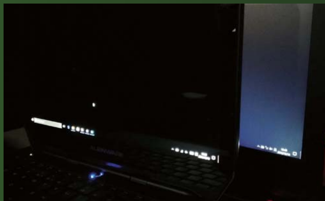
Alienware 13 R2的OLED屏（左）与常见游戏本的IPS屏（右）显示纯黑内容的效果对比示意，OLED的优势在这种情况下体现得十分明显，对于厌倦了“漏光屏”的用户而言是不错的选择
