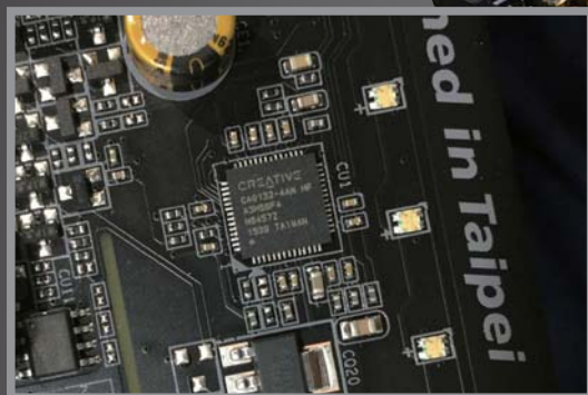
■ 音频部分采用Creative CA0132-4AN音频芯片,支持虚拟5.1环绕音效。
