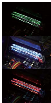
>> 金泰克天启X5内存的温控呼吸灯可随内存温度的变化而改变颜色
