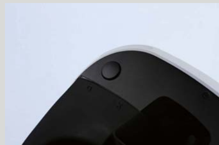
>>底部也设置有一个按钮，在佩戴完成后，通过这个按钮可以调节眼睛与镜片间的距离。
