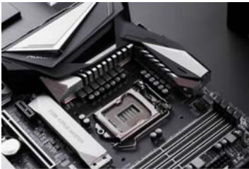
超强 12+2 相服务器级供电, 为 Core i9 9900KS 提供充足而稳定的电力
