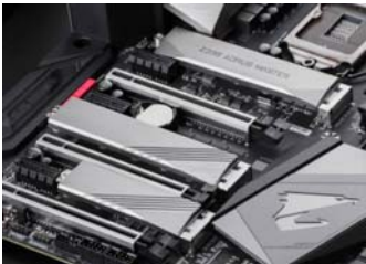
超强防护, 显卡插槽全部配备合金装甲, M.2 插槽全部覆盖散热装甲
