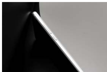
铝合金中框采用了弧形设计,边缘过渡比较平滑,音量键和电源键放置在精致的凹槽里,美观且手感舒适
