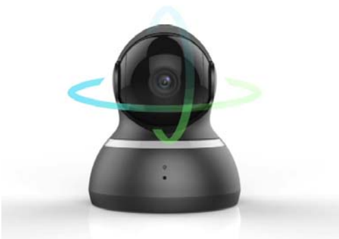
发展到现在,部分智能摄像机的镜头可以支持水平345°、垂直115°灵活转动,全景监控无死角
