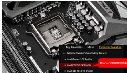
仅需在 BIOS 中选择预设的 5GHz 超频档案, 即可实现一键超频 5GHz
