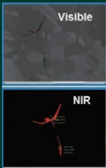
近红外成像中硅太阳能电池的裂纹很明显
