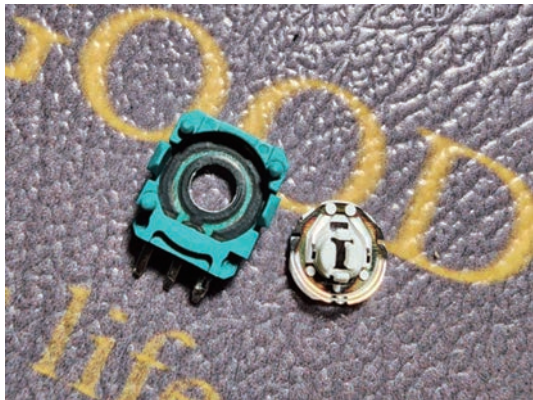
拆解开的碳膜摇杆，可以看到一圈碳膜电阻
