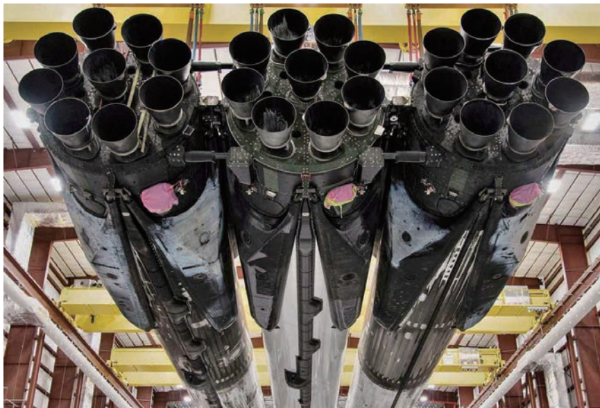
为了弥补猎鹰9号高轨运载能力不足的问题，重型猎鹰疯狂堆砌了27台梅林1D发动机
