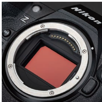
尼康 Z9 的堆叠式 CMOS 传感器是 20 世纪 90 年代第一批 CMOS 传感器的后代
