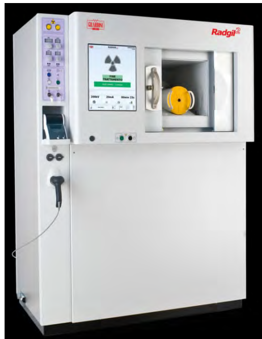
对血液制品进行伽马辐射的仪器
