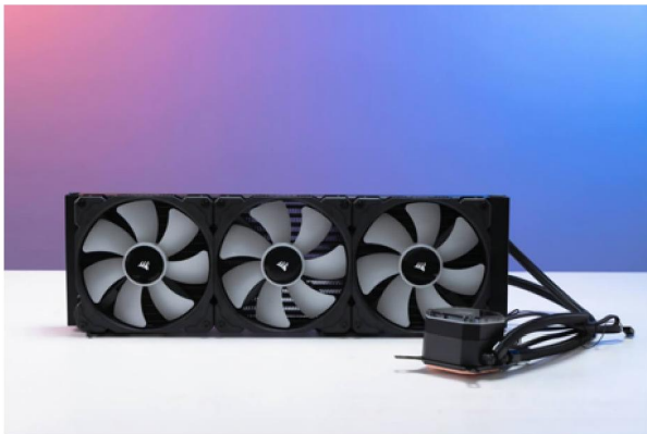
相比 H150i,H170i 的冷排升级到了 420mm,散热面积进一步提升
