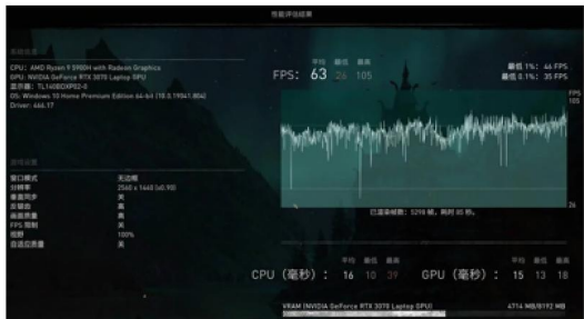
▲较新的《刺客信条:英灵殿》,对硬件的要求进一步提升,2.5K高画质平均63fps,流畅。不过,钛坦Plus的i7 11800H+130W RTX 3060(独显直连)可跑到76fps,领先较多
