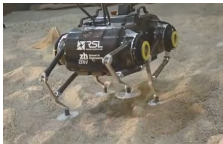
机器人平面脚底板设计成了扁平的旋转圆盘
