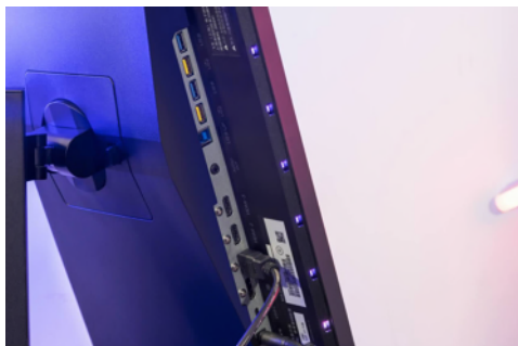
显示器底部的接口,亮点在于提供了 3 个 HDMI 2.1 接口和 1 个 USB-C 接口
