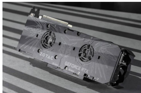
显卡背板装甲上“天启之翼”的位置预留了两个安装背板风扇的卡位
