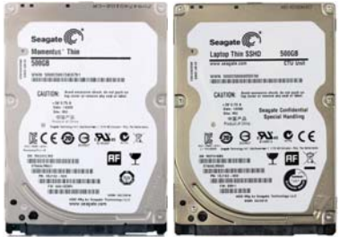
左为希捷 500GB 硬盘 ST500LM021, 右为希捷混合硬盘 ST500LM000
