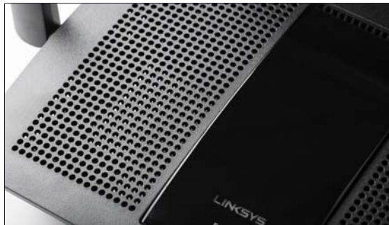
为了增强散热, 无线路由器正面都布置了大量散热孔
