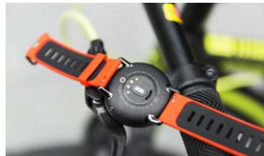
手表底部集成了心率监测功能,可以看到手表是采用触点式充电方式
