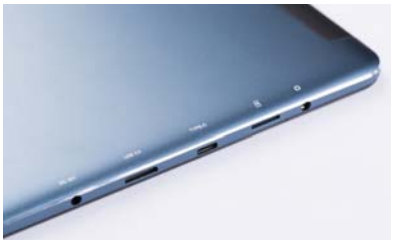
机身提供了较为丰富的接口,支持 HDMI 输出并且附赠了输出线,方便连接显示器
