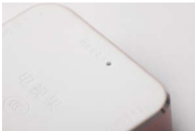
整个机身并没有配备实体按键,但底部设计了一个复位孔
