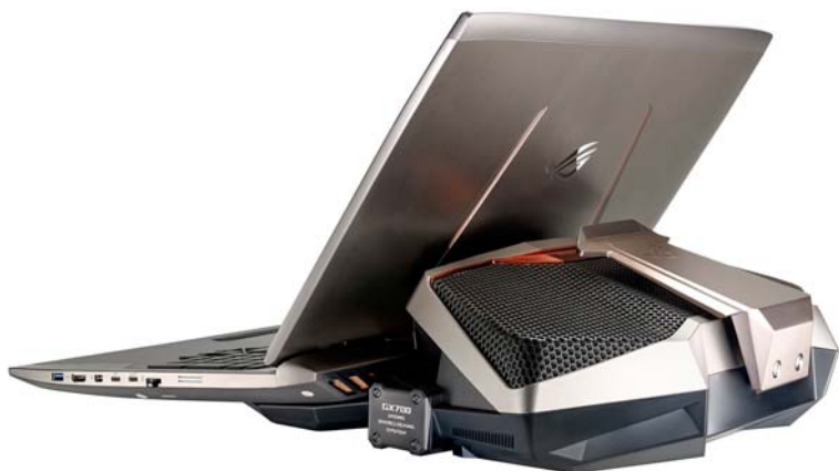
全球第一台采用水冷散热的笔记本,可见 GTX 980 独显再加上预超频的 Core i7 6820HK 处理器对散热要求之高
