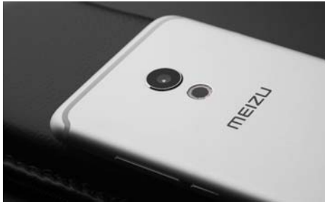
别具一格的天线设计和环形双色温闪光灯让魅族PRO 6的辨识度非常高,摄像头模组依然略微凸出机身
