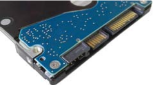
标准的SATA 6Gbps接口，最高读取速度133MB/s
