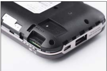
各种卡槽、螺孔被隐藏到后盖里面,SIM卡槽的设计使得拔卡变得非常困难
