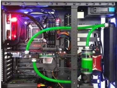
开放式水冷系统可自由搭配水冷配件,个性化十足
