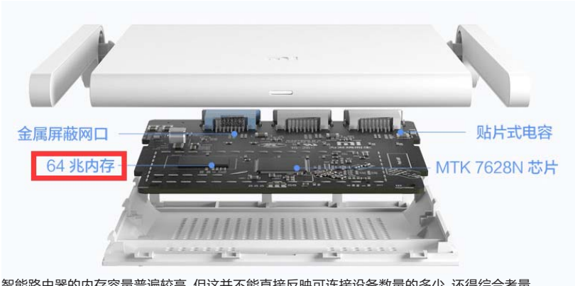
智能路由器的内存容量普遍较高,但这并不能直接反映可连接设备数量的多少,还得综合考量
