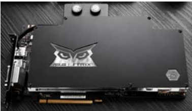
STRIX GTX980Ti 水冷版搭配了定制的开放式全覆盖水冷头,散热效果和颜值一流
