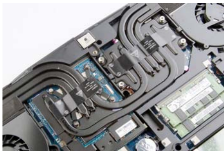
G155P 依然采用双风扇散热系统,热管数量多,但即便如此要 Hold 住桌面 i7 也很麻烦
