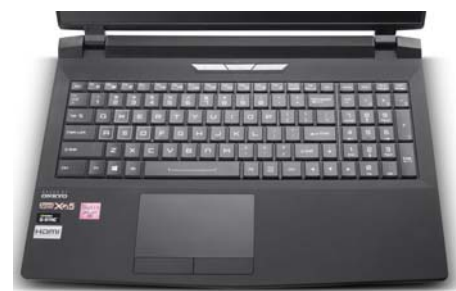
该机的输入体验还算不错,但在满载的情况下 C 面中部的最高温度可达 46℃(室温 20℃),不建议用它来长时间玩游戏
