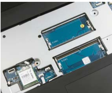
除此之外,在键盘下方还有 2 个闲置的 DDR4 内存插槽,可进一步提升性能
