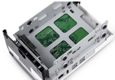
无论是拆开威联通 TAS-268的外壳还是拆下硬盘,都不需要工具
