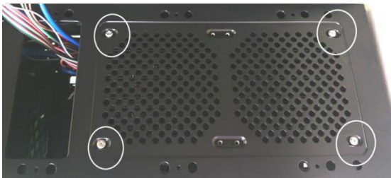
取下机箱顶盖,即可用螺丝钉固定240mm水冷排
