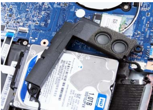
宏碁的高性能主力暗影骑士2并没有独立的低音单元,但它的两个扬声器都采用了双单元设计,因此表现同样不落风
