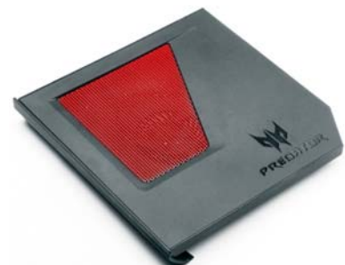
当然,也有宏碁掠夺者G9-791这种在基于双风扇主散热器之余,还能搭配光驱位进气风扇的设计
