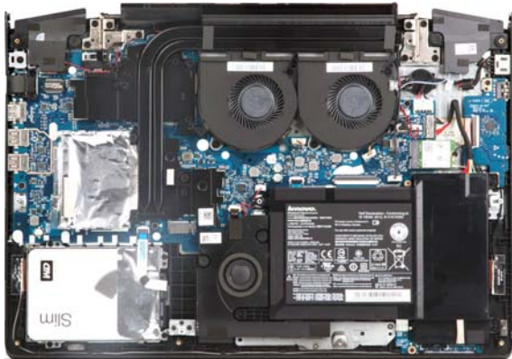
Y700 的内部设计紧凑,布局规整,虽然没有采用框架结构,但整体来看依然是本次参测产品中的优秀水准
