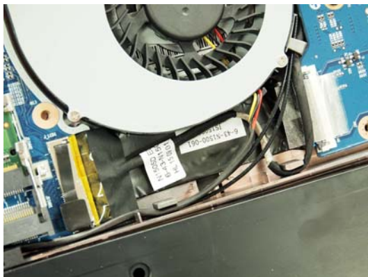
左侧的功能 PCB 虽然也是靠线材与主板连接,但并不是飞在空中容易被“误伤”的飞线,而是紧贴 C 壳走线,这个设计很聪明
