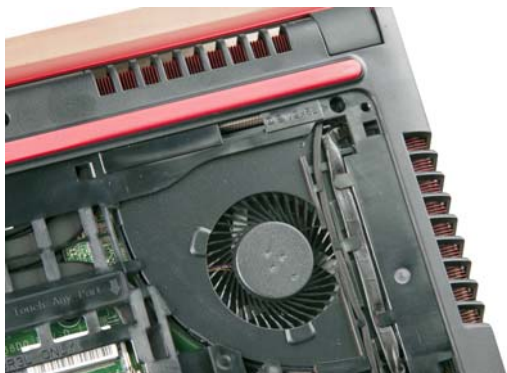
细心的读者朋友应该注意到了，Inspiron 15 7000 游匣版的一侧散热器采用了双出风口，因此整机有三个出风口
