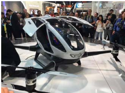
放大的载人版无人机亿航184,机身主体由四轴八桨的动力系统、单人机舱和行李后备厢构成
