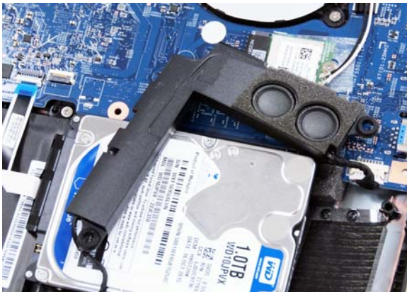
592G 有 2 组扬声器单元，每个又各有 2 个单元，这算是本次参测产品中较为独特的设计了
