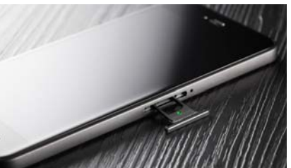
整合了按键功能的 SIM 卡槽,正面用一颗绿点进行标注,方便用户插入时识别
