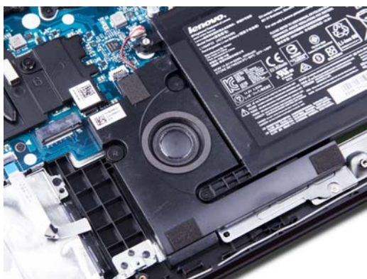
该机采用了本次参测产品中体积最大的扬声器单元,而且是 2.1 声道结构,所以它能在听音表现上夺魁也属情理之中了 层处理,实际效果是 Y700 的散热很棒。
