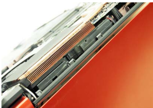
该机的扬声器被挤压在散热器下方靠近 C 面的位置，空间有限，所以功率也大不起来
