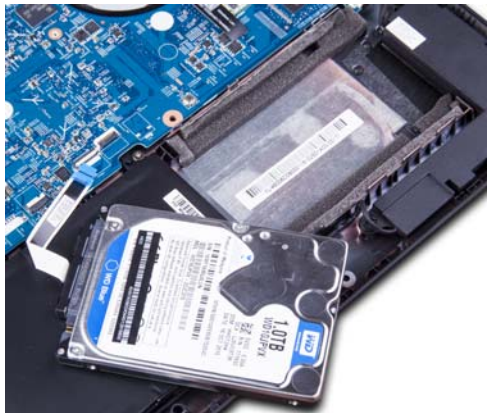
不过该机的 2.5 英寸硬盘位并未使用螺丝，而是用海绵支撑固定，虽然可以降低震动影响，但在几番拆装之后就不容易还原了
