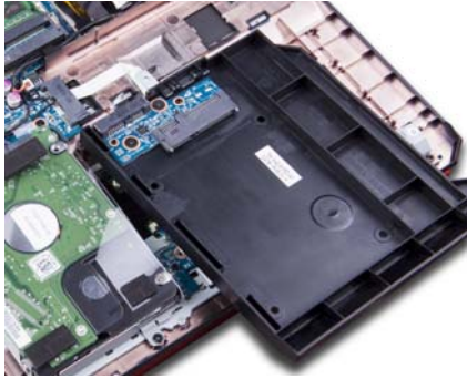
除此之外该机还预留了光驱位硬盘托架,玩家只需买来 2.5 英寸硬盘就能直接升级使用了
