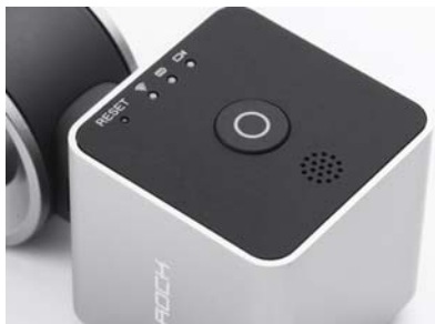
RESET 键和 WiFi、电源、视频指示灯在同一个面上,开机键有些生硬
