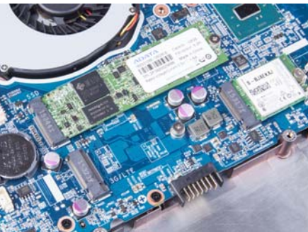
G150T 大圣本预留了 3G 模块升级接口,侧面也有 SIM 卡插槽,只是没有预埋天线
