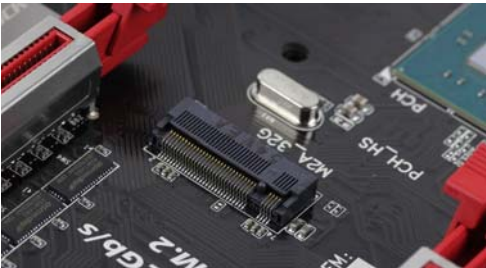
提供两个32Gbps速率的M.2接口，是技嘉GA-Z170X-Gaming 3的一大亮点
