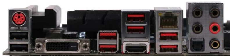
微星 Z170A GAMING PRO虽然提供了6个USB 3.1 Type-A接口，但其仅为Gen1规格，速率为5Gbps，比USB 3.0快不了多少
