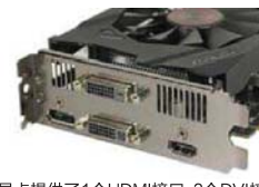
显卡提供了1个HDMI接口、2个DVI接口以及1个DisplayPort接口,属于GTX 950的主流配置
