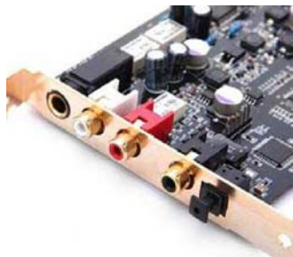
声卡有光纤输出就可以直接接驳到音箱上。另外,目前不少电视也有光纤数字音频输出功能。游戏主机也有光纤音频输入接口。
