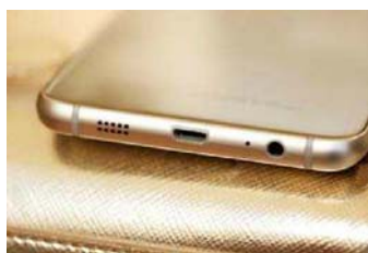
上下两颗降噪麦克风都没有位于中线打孔,细节处理不够完美,处女座可能会受不了
