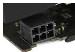
显卡采用单6pin接口供电
