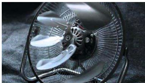
在拍摄高速移动的物体,比如转动的风扇叶片时,逐行扫描曝光的幕帘快门可能会让像素曝光时差从照片上体现出来,出现诡异的拍摄图片,而电子快门则不会出现这个问题
