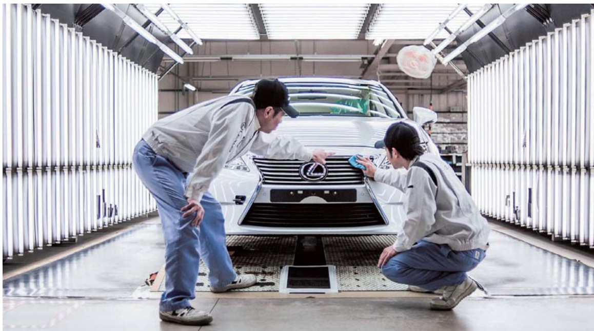
所有被机器喷涂过的汽车必须再经人工细心检查，然而一层喷漆只有纳米级的厚度，即使在荧光灯下想要分辨细线和斑点也绝非易事
